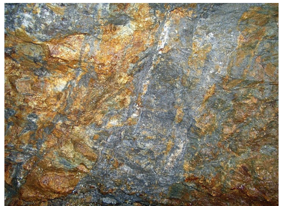
図10. 生野鉱山 熱水鉱床(れっか充填鉱床)
